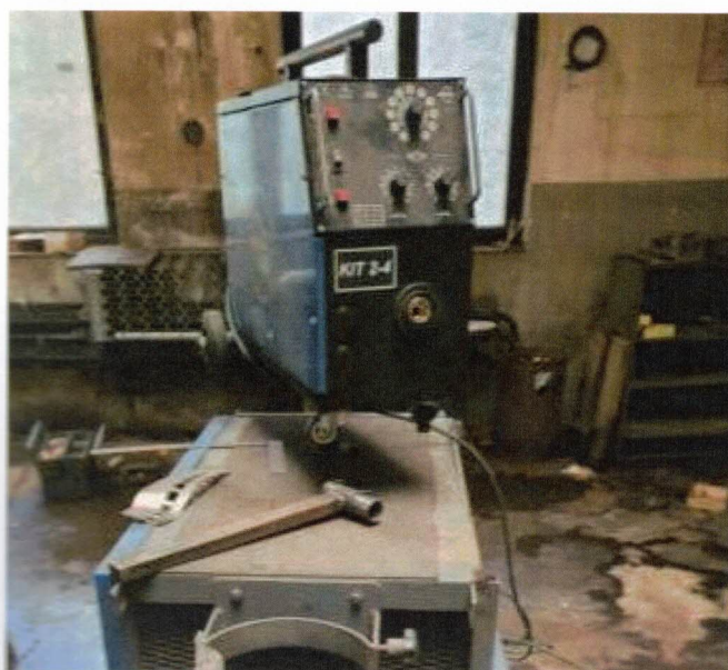
7/4 Agregát Kühlreiber s.r.o. : KIT 2_4 – přídavné zařízení ke svářečce – jednotka posuvu drátu, v.č.: 30 577
