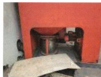
7/4 Agregát Kühlreiber s.r.o. : KIT 2_4 – přídavné zařízení ke svářečce – jednotka posuvu drátu, v.č.: 30 577
